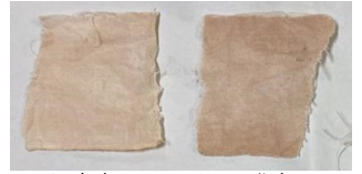
▲未処理 ▲豆乳処理
